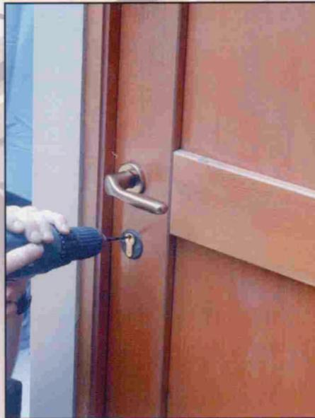
▶ Una serratura a cilindro può esser facilmente violata usando un trapano portatile a batteria, opportunamente silenziato per ridurre il rumore dell'attacco.
